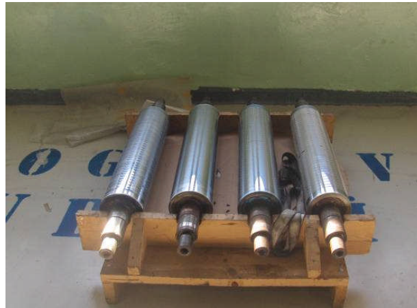
Şekil 4. 2: Boncuklaşma problemini çözmek için yeni kalıp silindiri hazırlayın.
