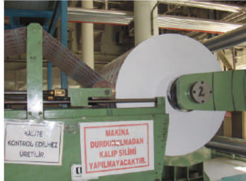
Şekil 4. 3: Bloklaşma problemini çözmek için bobin sarım basıncını azaltınız.
