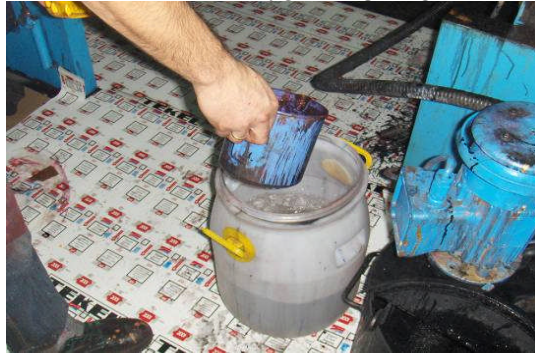
Şekil 3. 2: Yavaş kuruma problemi yaşanınca hızlandırıcı solvent kullanınız.
