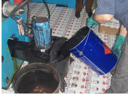
Şekil 2. 2: Kötü transfer oluyorsa mürekkep ilave ediniz.
